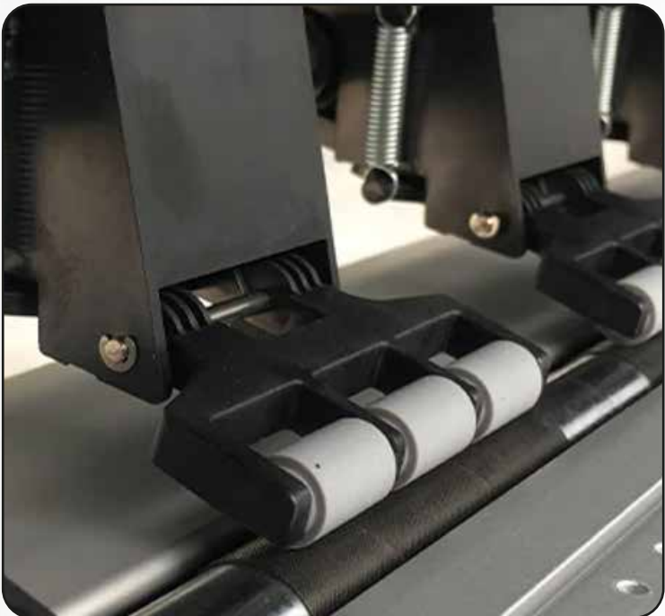
RODILLO DE PRENSADO DE PAPEL DE ALTA PRECISIÓN
