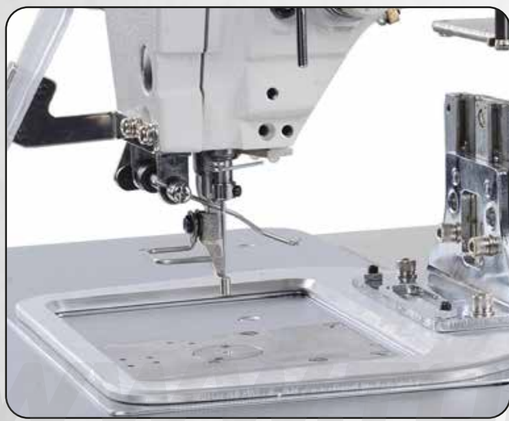
ALTURA DE PRENSATELA: 22MM
